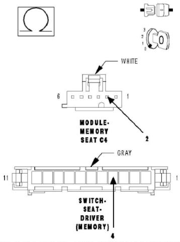
6). CHECK THE (P599) DRIVER SEAT SWITCH MUX RETURN WIRE RESISTANCE
