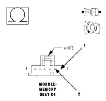
3). CHECK THE (P339) DRIVER SEAT FRONT VERTICAL/RECLINER SWITCH MUX CIRCUIT RESISTANCE
