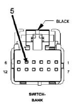
4). CHECK (G104) PASSENGER AIRBAG INDICATOR DRIVER CIRCUIT FOR A SHORT TO GROUND
