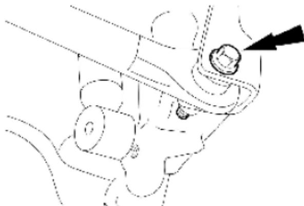
11) . 拆开车轮转向节上的上控制臂。
