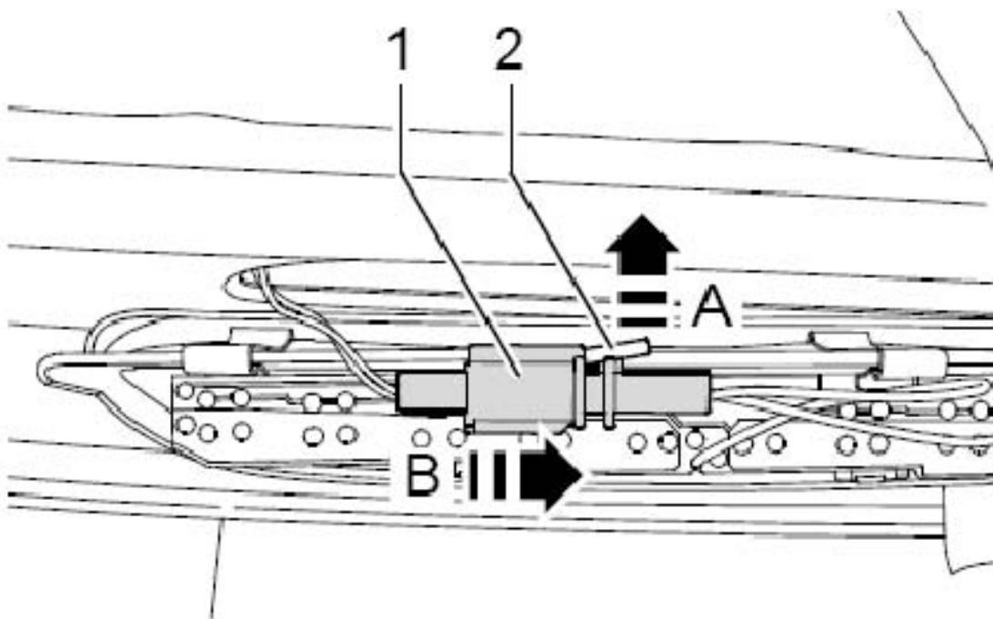
6). 沿(下图箭头所示)方向松开卡子(下图1所示), 断开插头(下图2所示)。
