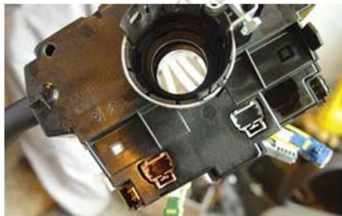
控制模块上的 6 针插座出了问题
