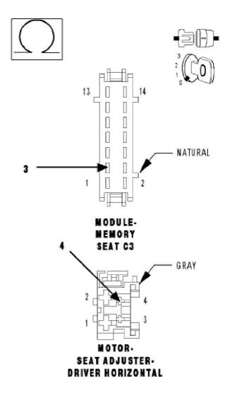
6). CHECK THE (G491) DRIVER SEAT HORIZONTAL SENSOR GROUND FOR AN OPEN
