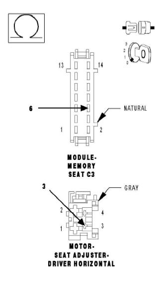
7). CHECK THE (P115) DRIVER SEAT HORIZONTAL FORWARD DRIVER WIRE FOR AN OPEN
