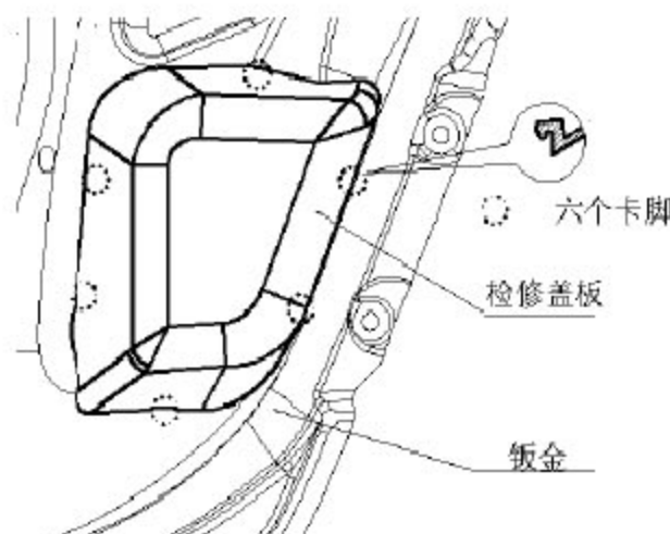
图 8 行李箱盖右尾灯检修口盖拆卸示意图
