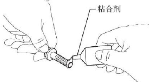
C). 紧固 6 个传动板和变矩器离合器固定螺栓。
