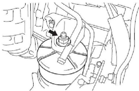
9). 暂时紧固发动机左侧悬置隔振垫
