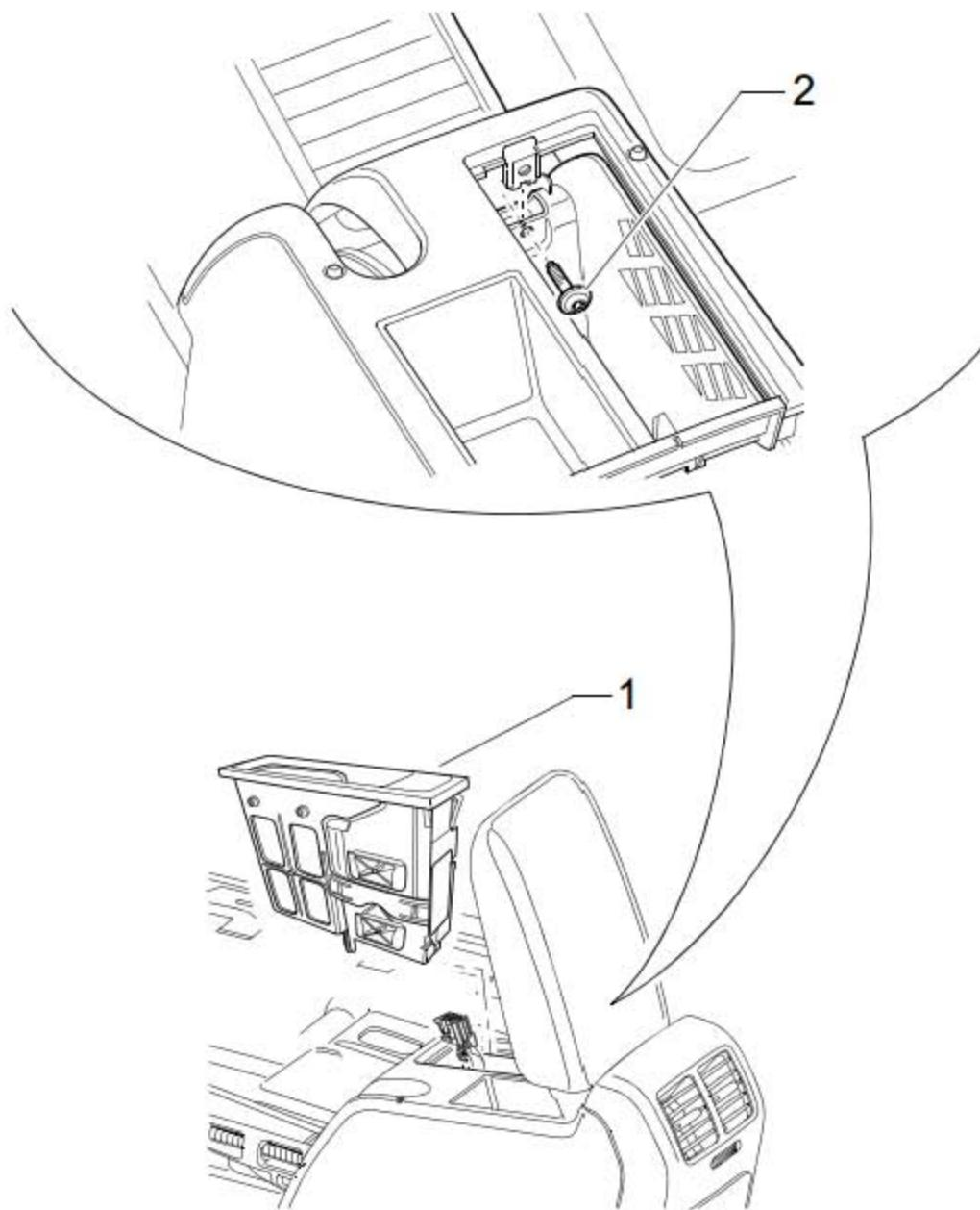
18). 拆卸多媒体控制单元(图中 1 所示)。
