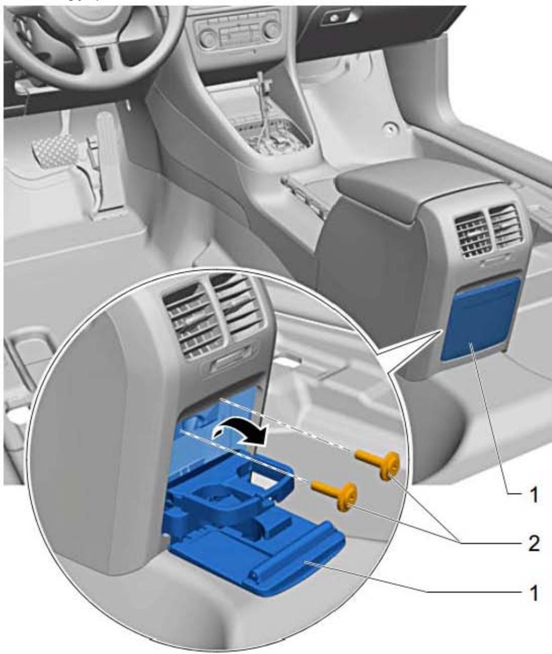
1). 打开饮料托架(图中 1 所示), 拧出两个螺栓(图中 2 所示)。
