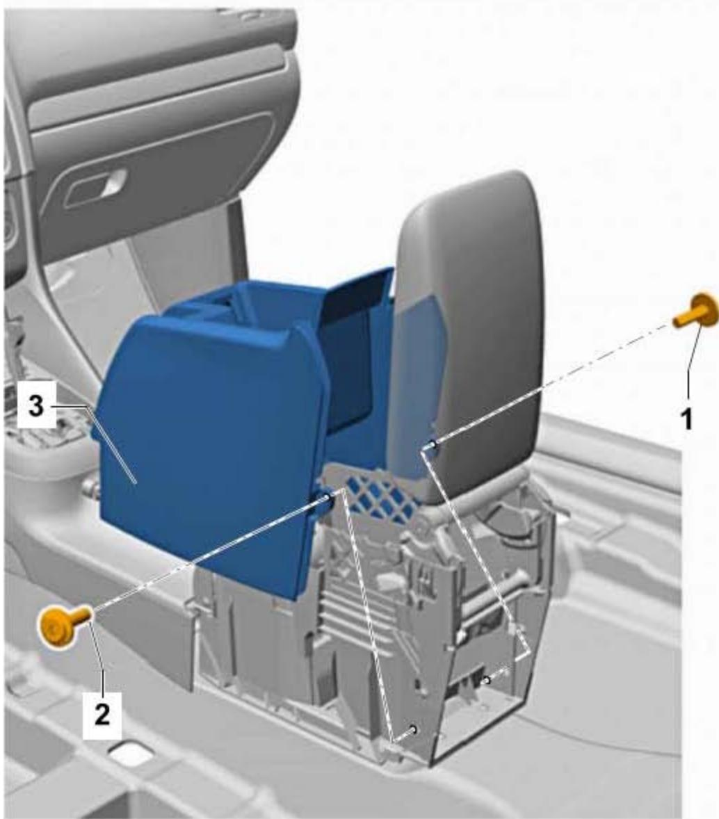
23). 拧出螺栓(图中1所示)和(图中2所示)。
