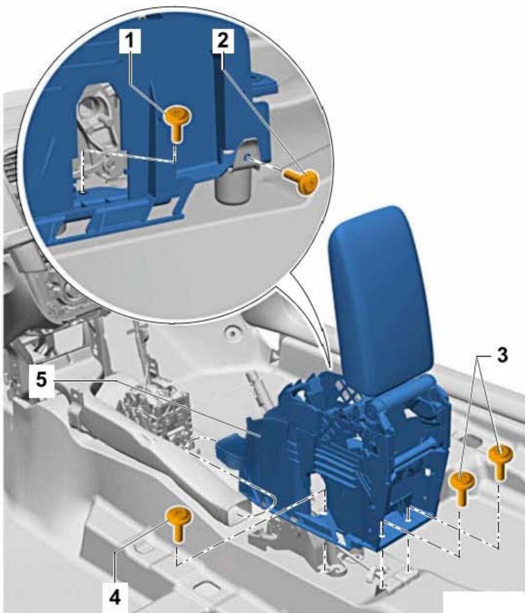
26). 调节前排座椅，拧出螺栓(图中 1 所示)、(图中 2 所示)、(图中 3 所示)和(图中 4 所示)。
