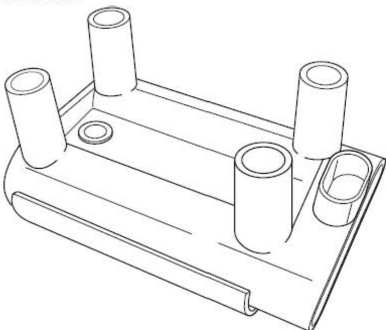
点火线圈总成包括两组线圈，线组为两个相差360 度曲轴转角的气缸火花塞提供点火能量。点火是在活塞运行至压缩上止点和排气上止点同时进行。处于排气上止点附近的气缸因内部气压低，且温度高，较少点火能量就可使火花塞的电极击穿点火，称之为多余点火。而处于压缩上止点气缸内的混合气密度和压力较高，所以较多的点火能量使该气缸火花塞点火，混合气体迅速被点燃作功，这个气缸的点火称为有效点火。
