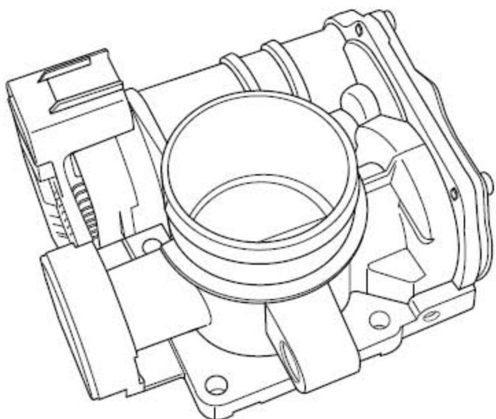
电控节气阀体总成的节气门开度大小由ECM 根据驾驶人员控制的节气门踏板控制输入信号，以及其他各种传感的输入信号，计算出车辆在该时刻和该
