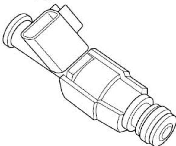
喷嘴结构是一个电磁开关的球阀装置。线圈引出两极经过发动机线束与ECM和电源相连，线圈受ECM控制对系统接地导通后，产生磁力克服弹簧力、燃油压力和岐管的真空吸力，吸起阀芯，燃油通过阀孔座从导向孔喷出，雾状地喷到进气门处，断电后，磁力消失，在弹簧力及燃油压力下，喷嘴关闭。燃油喷射器的顶部采用橡胶密封圈与燃油导轨接口形成可靠压力燃油密封；下部同样采用橡胶密封圈与发动机进气岐管对空气密封。燃油喷射器电阻值11.6-12.4Ω。
