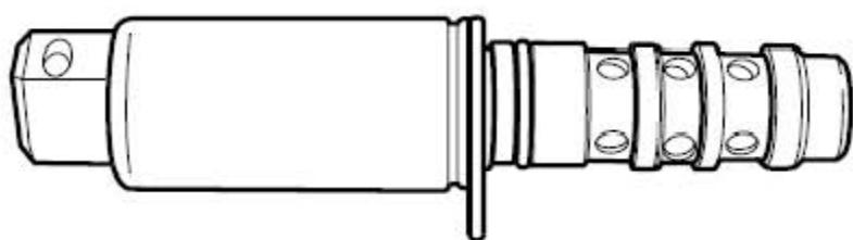
VVT 电磁阀位于进气岐管边, 靠近发动机前端。VVT 磁阀为4位4 通电磁阀, 工作电源由受ECM 控制的主继电器提供, ECM以脉宽调制信号控制VVT 电磁阀搭铁, 可连续改变曲轴相对于凸轮轴的正时关系发生, 使发动机在不同的运转功况下得到需要的最佳配气相位, 实现对配气相位的控制。将有助于提升发动机效率、改进怠速稳定性并可提供更大的扭矩及功率, 同时有助于提高燃油经济性并降低碳氢化合物以及氮氧化物的排放。电磁阀电阻值: 20 °C(68°F)时7.2 Ω
