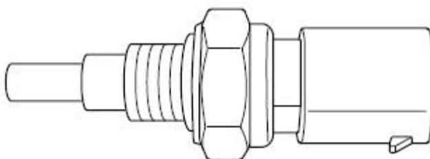
冷却液温度(ECT)传感器用于检测发动机的工作温度，ECM 根据不同的温度，为发动机提供最佳的控制方案。传感器采用负温度系数的热敏电阻作为感应元件，当冷却液温度升高时，阻值下降。在 $-30^{\circ}\text{C}$ ( $-22^{\circ}\text{F}$ ) 时电阻值为 $26000\Omega$ ；在 $130^{\circ}\text{C}$ ( $266^{\circ}\text{F}$ ) 时，电阻为 $90\Omega$ 。传感器安装在主水道上。冷却液温度信号对点火正时及燃油喷射量的修正值至关重要，同时该信号还通过CAN 网络传输给仪表(IP)，用于显示当前发动机的工作温度。
