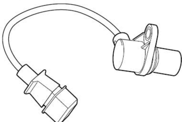
曲轴位置传感器的输出可用于决定曲轴旋转位置和转速。曲轴位置传感器为磁电式传感器，它安装在变速箱前端壳体上，用螺栓固定，位于冷却液温度传感器下部。传感器信号盘与曲轴飞轮是一个整体，传感器与信号盘齿的间隙在0.3-1.5mm(0.01-0.06in)，信号盘上面有58个机加工槽。曲轴传动时，58X的齿顶和齿槽以不同的距离通过传感器，传感器感应到磁阻的变化，这个交变的磁阻便产生了交变的输出信号，而58X齿圈上的缺口位置与发动机上止点的位置相对应，在第一缸上止点时，传感器对准58X齿圈第20个齿的下降沿，ECM利用此信号确定曲轴的旋转位置和转速。
