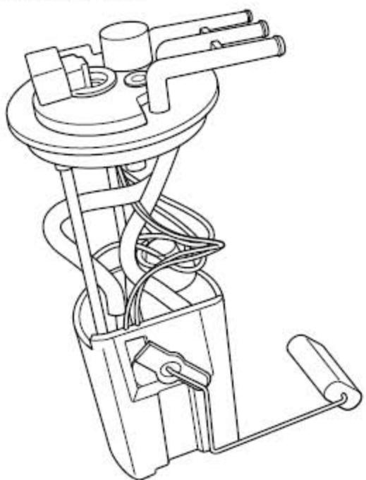
燃油泵总成是由油泵、支架、油位传感器、油压调节器(无回油式设计)组成，其功能就是为了系统提供足够压力的燃油，同时向驾驶仪表提供燃油箱油量信息，燃油泵总成安装于油箱内部。燃油泵为涡轮式单级电动燃油泵，由ECM通过燃油泵继电器控制工作，与联合电子控制系统不相同的是，本控制系统对燃油泵继电器控制电源。油泵的出口处设计有单向阀，在发动机不工作时，油管内的存油不会迅速回泄到油箱，以保证再次起动性能。油位传感器为可变滑片电阻型。燃油泵输出燃油压力大于350kPa。
