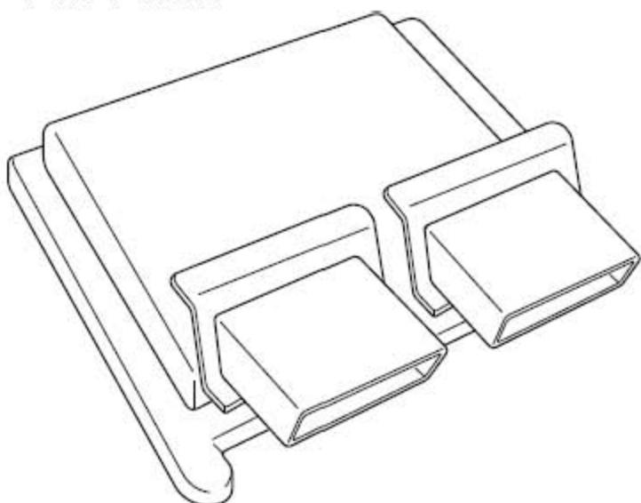
发动机控制模块是一个以单片机为核心的微处理器。它的功能就是处理来自整车不同部位的传感器数据, 判断发动机的工作状况, 再通过执行器对发动机的各执行器进行准确的控制。ECM 正常工作电压9. 0V-16V
