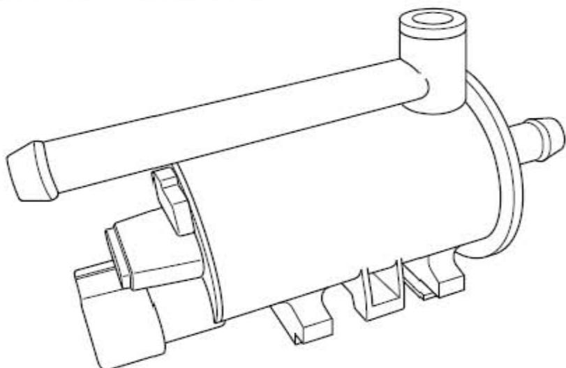
碳罐控制阀位于发动机缸盖侧面(变速器侧)用于控制碳罐清洗气流的流量。ECM 通过碳罐清洗控制电磁阀控制从碳罐进入进气歧管的汽油蒸气量, ECM 对其输出脉冲方波, 通气量与控制脉冲方波的占空比呈线性关系。
