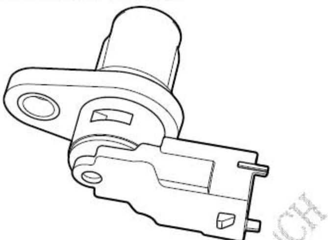
凸轮轴位置传感器为霍尔效应式传感器，它安装在进气凸轮轴附近，与凸轮轴上的信号轮共同工作，信号轮对应着发动机特定位置，ECM 通过该传感器测得数字电压信号，以此确定发动机工作的气缸，并实施一对一的控制。发动机控制模块由此可计算实际的燃油喷射顺序。如果在发动机运行时凸轮轴位置传感器信号丢失，燃油喷射系统将转换到根据最后一个燃油喷射脉冲计算的顺序燃油喷射模式，而发动机将继续运行。若发动机熄火再次启动，燃油喷射顺序由顺序转为分组。即使故障存在，发动机也可以重新启动。
