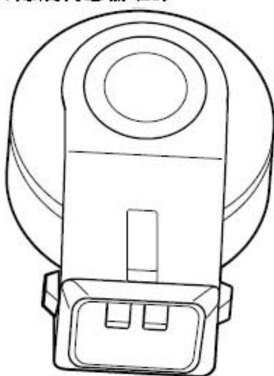
传感器是一种频响应式传感器，装配在发动机缸体最爆震最感应最灵敏部位，进气歧管下部。ECM 利用爆震传感器探测爆震强度，进而修正点火提前角，对爆震进行有效控制，并优化发动机的动力性，燃油经济性和排放水平。如果发动机产生爆震，ECM 会接受到这个信号，滤去非爆震信号并进行计算，通过凸轮轴与曲轴位置传感器信号判断发动机在工作循环中所处的位置，ECM 据此计算出几缸发生爆震，将会推迟此缸的点火提前角直到爆震现象消失。然后再次提前点火提前角直到使点火角处于当时工况下的最佳位置。由于传感器信号较弱，因此传感器引线采用屏蔽线。其电阻值大于 $1M\Omega$ ，在任何情况下输出信号都大于 $17mV/g$
