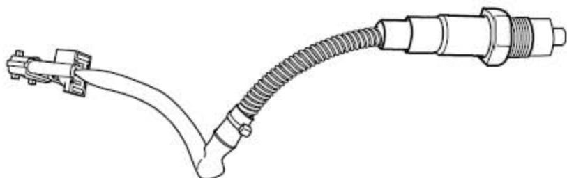
氧传感器是闭环燃油控制系统的一个重要标示性传感器，它调整和保持理想的空燃比，使三元催化净化器达到最佳的转换效率。当参与发动机燃烧的空燃比变稀时，排气之中的氧聚集含量增加，氧传感器的输出电压降低，反之输出电压值则增高由此向ECM 反馈空燃比的状况。
