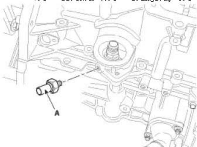
17). 安装爆震传感器 (A) 和机油滤清器 (B)。
