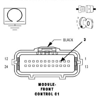
7). (D55) CAN B BUS (+) CIRCUIT SHORTED TO THE (D54) CAN B BUS (-) CIRCUIT
