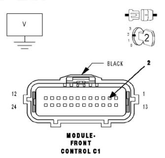
4). (D54) CAN B BUS (-) CIRCUIT FOR A SHORT TO VOLTAGE
