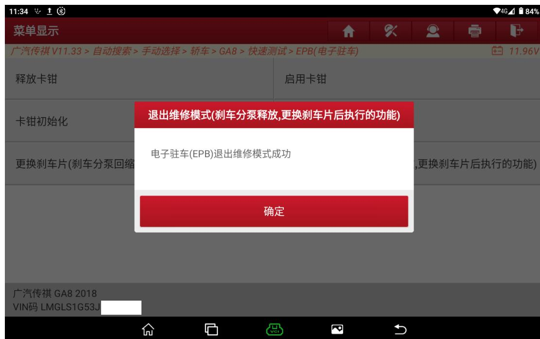
15. 检查车辆仪表，驻车维修灯消失，转为正常驻车灯，更换结束（如下图）。
