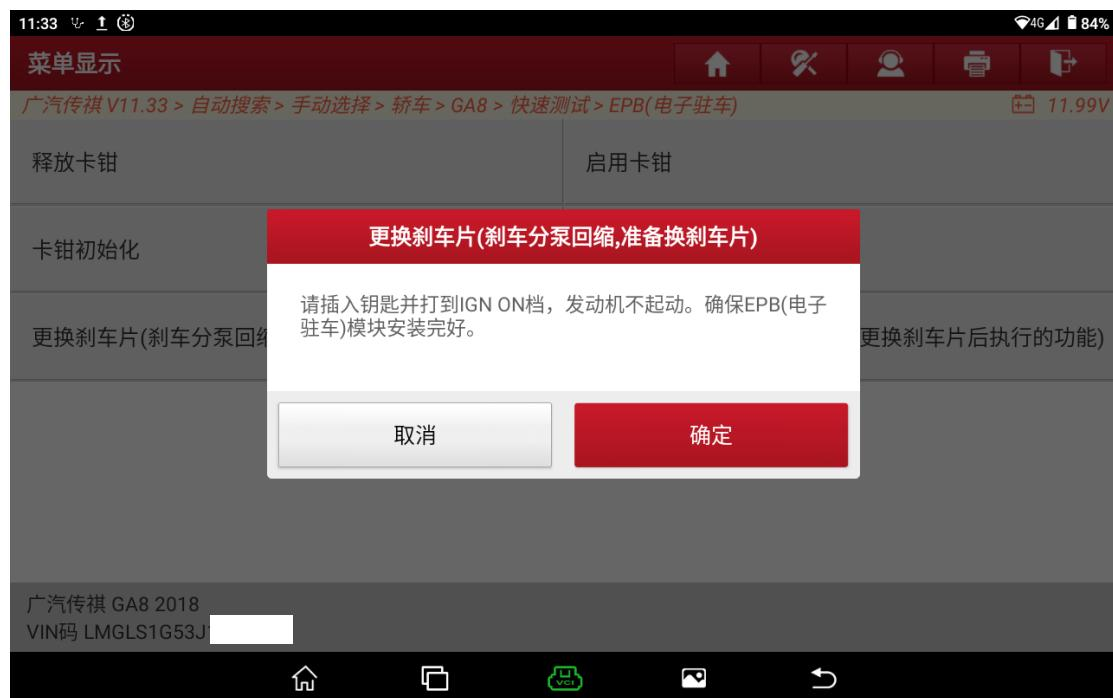
7. 满足条件“车辆停放平整的地面上，松开电子手刹”，然后点“确定”（如下图）；
