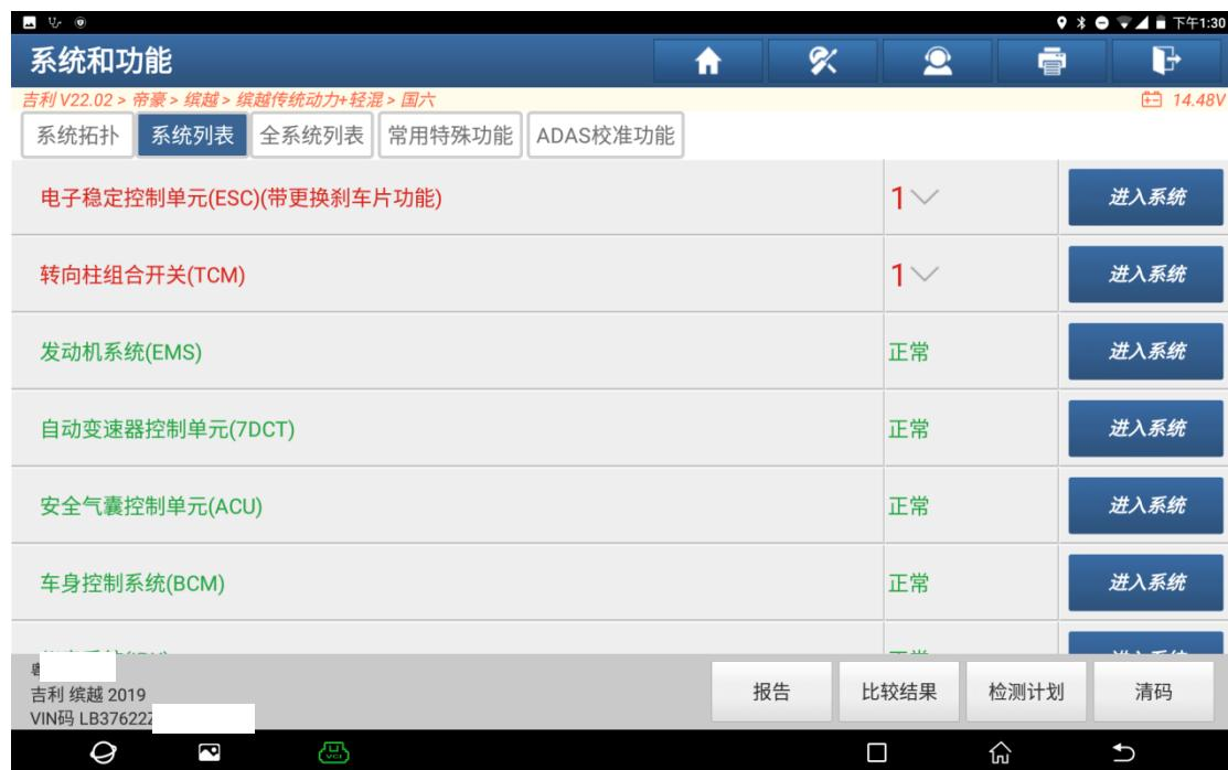
9. 读取数据流, 显示未标定状态, 摆正方向盘确认角度在±5° 之内 (如下图);
