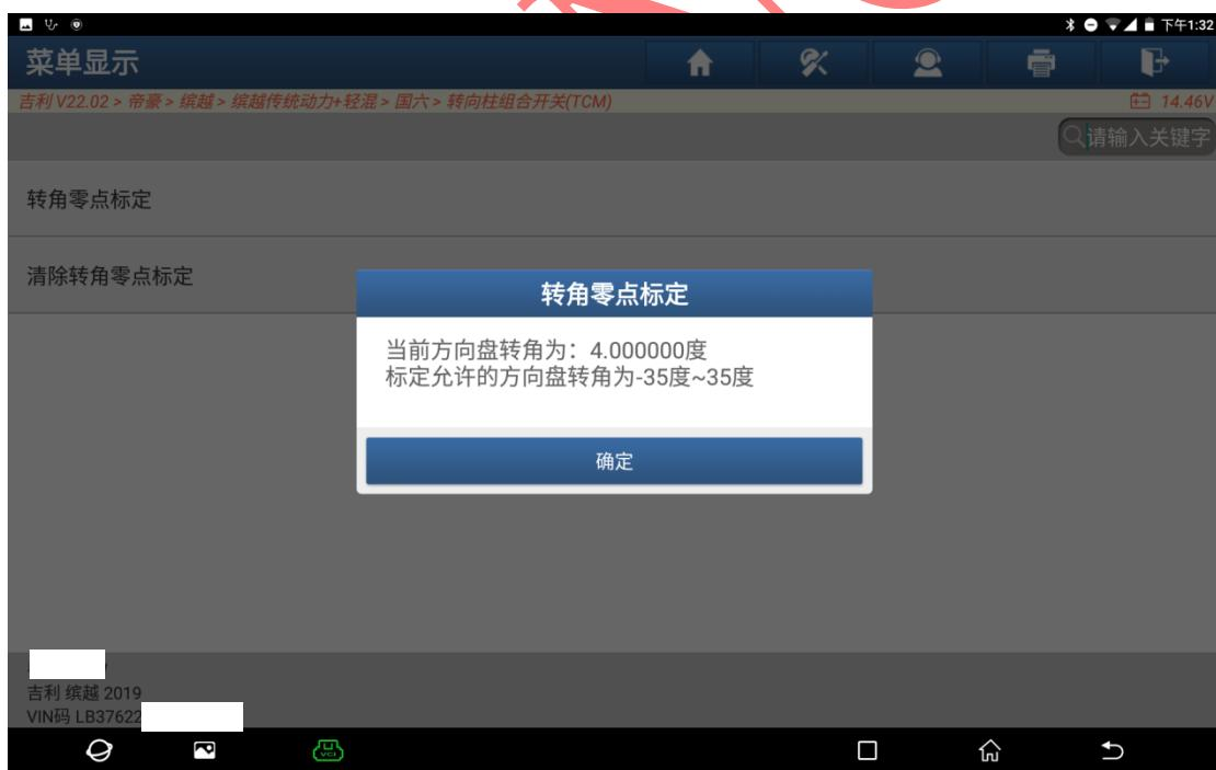
14. 提示“开始执行转向角标定，请勿操作方向盘”，点“确定”（如下图）；
