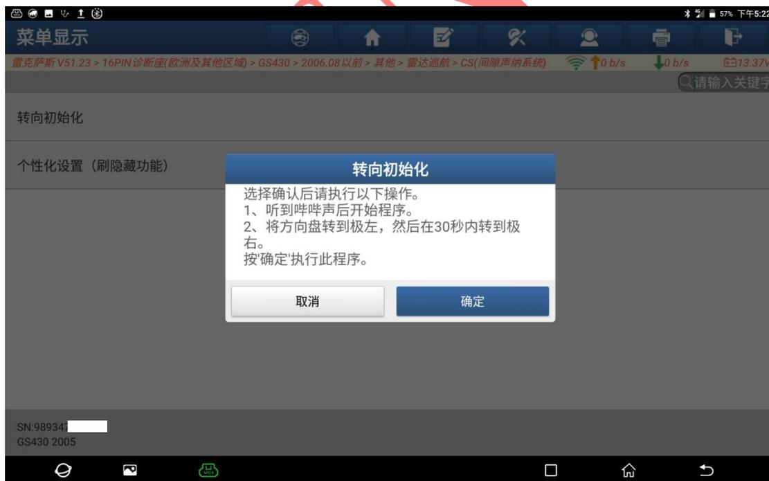
10. 提示“将方向盘向左打到底，然后在向右打到底”（如下图）；
