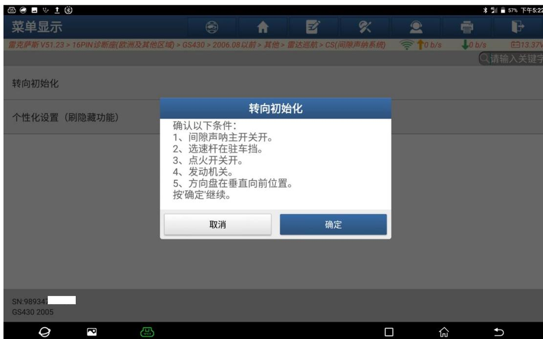
9. 阅读提示条件，点“确定”后根据提示条件操作（如下图）；
