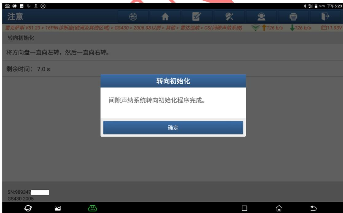
12. 清码后，重新读码，先“无故障码”，初始化完成（如下图）。
