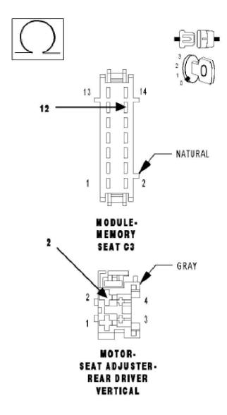
8). CHECK THE (P113) DRIVER SEAT REAR VERTICAL DOWN DRIVER AN OPEN
