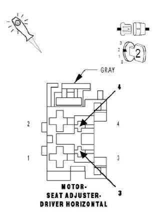
3). CHECK THE (G401) DRIVER SEAT HORIZONTAL POSITION SENSE WIRE FOR A SHORT TO GROUND
